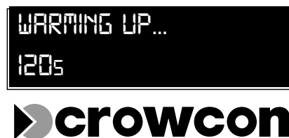
Figure 11 : Démarrage et préchauffage
